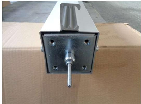
Lösen Sie die Mutter M6 DIN 985 mit Knarren-Ring oder Maulschlüssel SW10.
