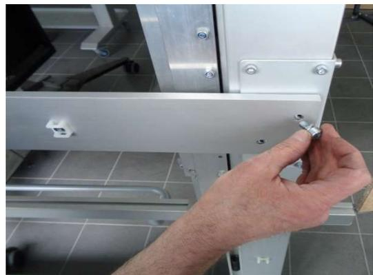
Pylone mit Pylonenverbinder komplett verschraubt.
