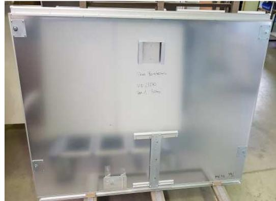
Der Galgenhalter wird mit 3 Schrauben M8 x 25 rückseitig an der dafürvorgesehenen Schiene befestigt.
