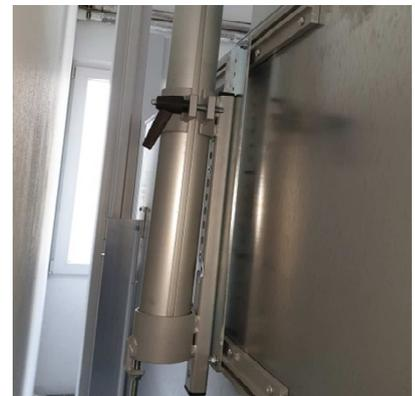
Die Federbolzen der Beameraufnahme sind für den jeweiligen Beamer typ vormontiert und werden mit diesem verschraubt.
