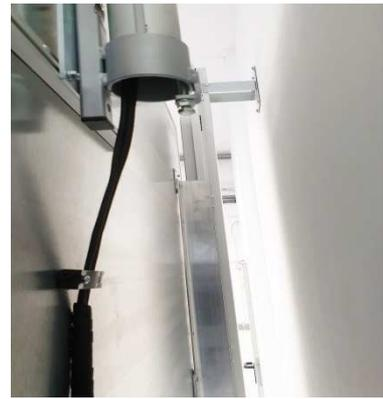
Der Umfang des Kabelschlauchs macht es unmöglich, dass die Kabel innerhalb der Führungen eingeklemmt werden können.
