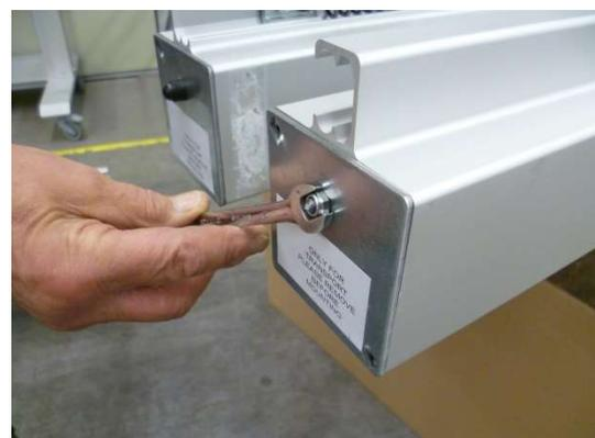
Bodenplatte entfernen und Stahlsicherungshaken aus dem angeschweißten Ring, der sich an der Unterseite der Pylonen befindet, entnehmen.
