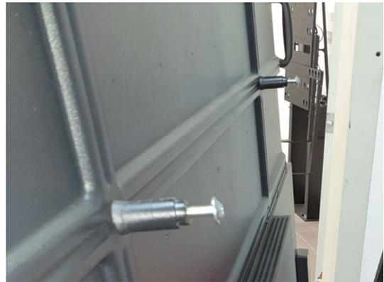
Die Schrauben werden anschließend in die Vesaaufnahmen des Rahmen eingehangen ...und anschließend angezogen.
