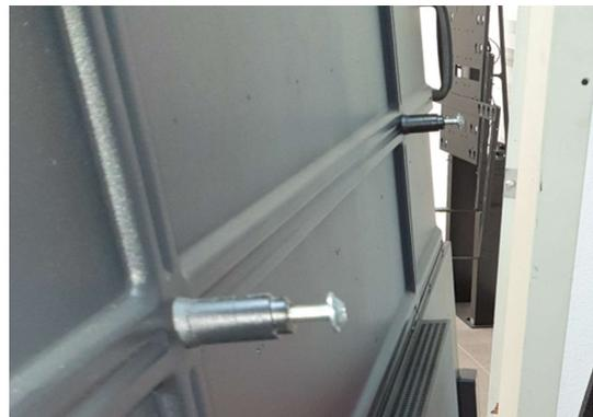
Die Schrauben werden anschließend in die Vesaaufnahmen des Rahmen eingehangen
