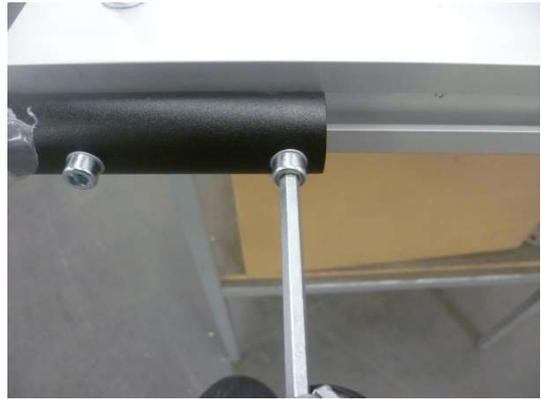
Den montierten Nutenstein lösen, in gewünschte Position schieben und fixieren. Anschließend Griff wieder befestigen.
