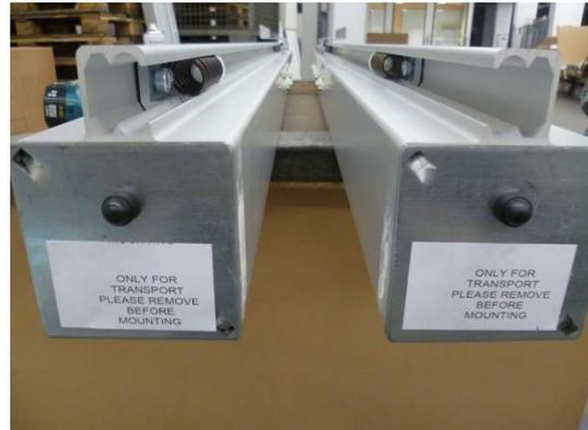
Zur Demontage der Transportsicherung die Plastikcappe abziehen und die darunter befindliche selbstsichernde Mutter komplett lösen.
