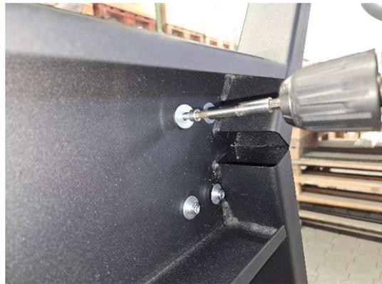
Stellen Sie das Fahrgestell und die montierten Hubsäulen auf die Rollen und schrauben Sie das Oberteil mit den gleichen Schrauben fest.
