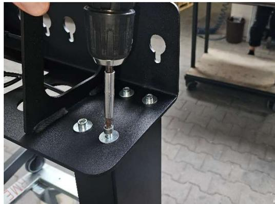
Befestigen Sie die Steuerung am Oberteil und verbinden Sie dieses mit den Säulen und dem Taster
